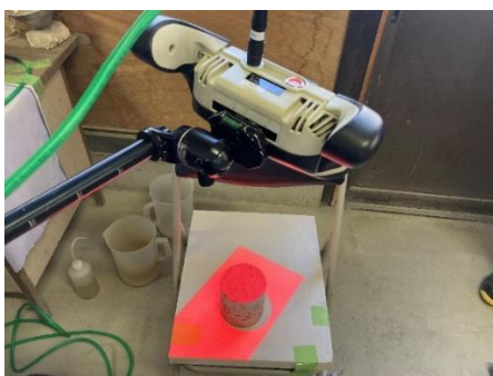
写真 2 打継面測定状況
