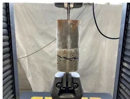
写真 3 直接引張試験状況
