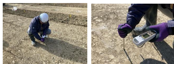
(左: 比抵抗値測定 遠景、右: 比抵抗値測定 近景) 写真5 比抵抗法
