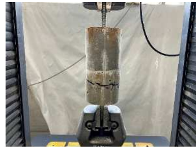
写真 4 直接引張試験 (試験後)
