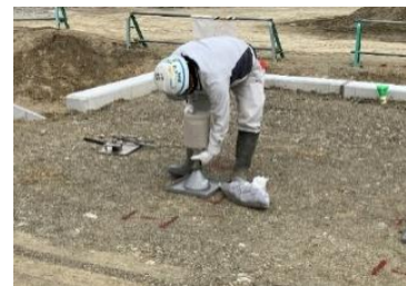
写真2 砂置換法の測定状況
