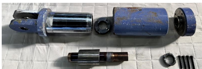
写真 5 回収した 40tf ダンパーの分解状況 (No. 594)
