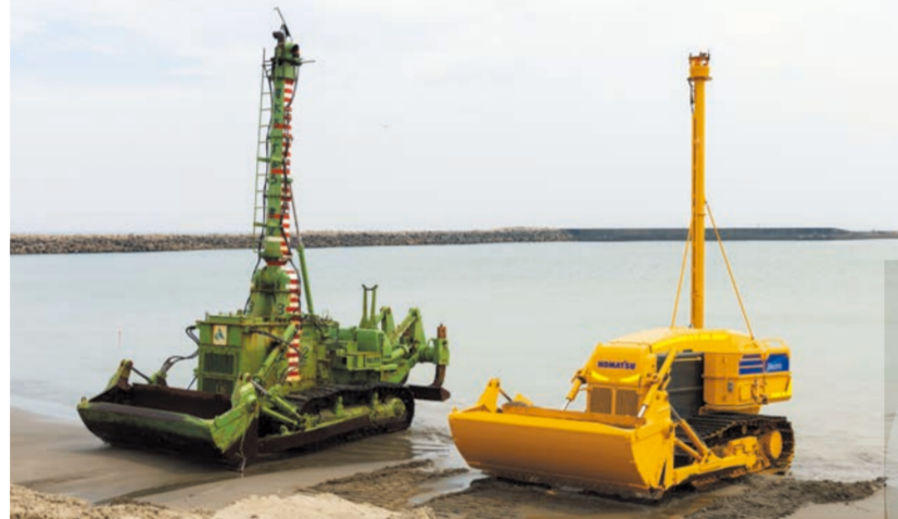
左：水陸両用ブルドーザ、右：水中施工ロボット（コンセプトマシン）
