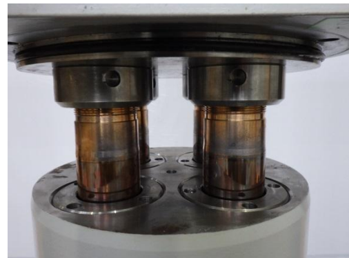
写真 1 ダンパー部の拡大
