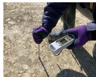
写真1 比抵抗法の測定状況
