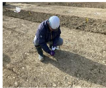
写真1 比抵抗法の測定状況
