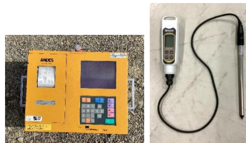
(左: RI法、右: 比抵抗法) 写真2 測定機器
