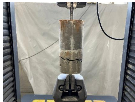
写真3 直接引張試験状況
