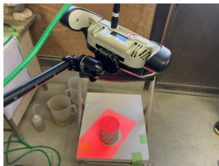
写真2 打継面測定状況
