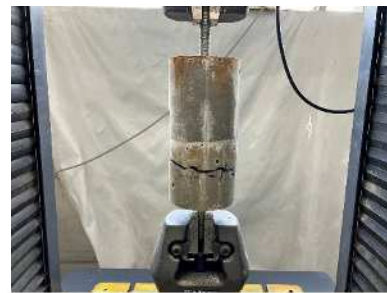
写真 4 直接引張試験 (試験後)
