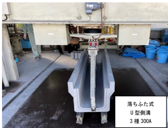
写真 2 曲げひび割れ耐力試験状況
