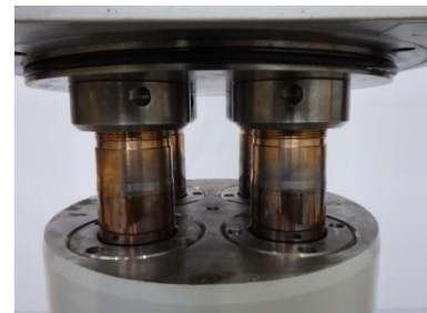
写真2 大容量摩擦ダンパー (ダンパー部拡大)
