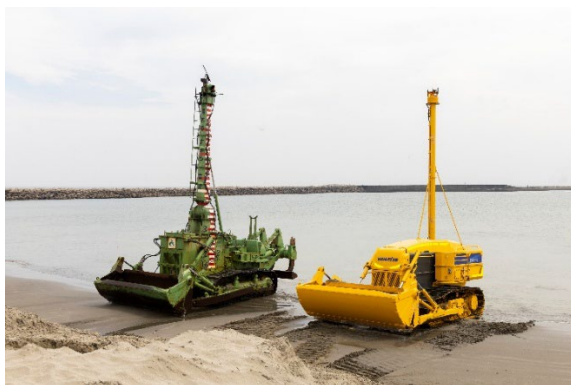
（左）水陸両用ブルドーザ、（右）水中施工ロボット コンセプトマシン
