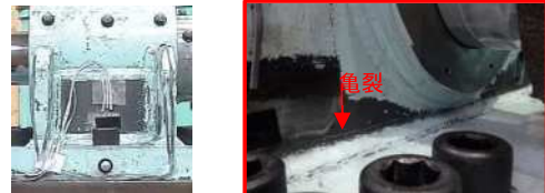
(b) ダンパー本体 (c) 亀裂発生部拡大 写真7 載荷後の試験体(固定タイプ_負側)
