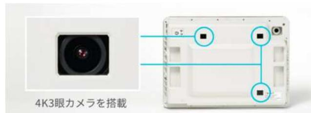
AI カメラ (配筋検査専用デバイス)
