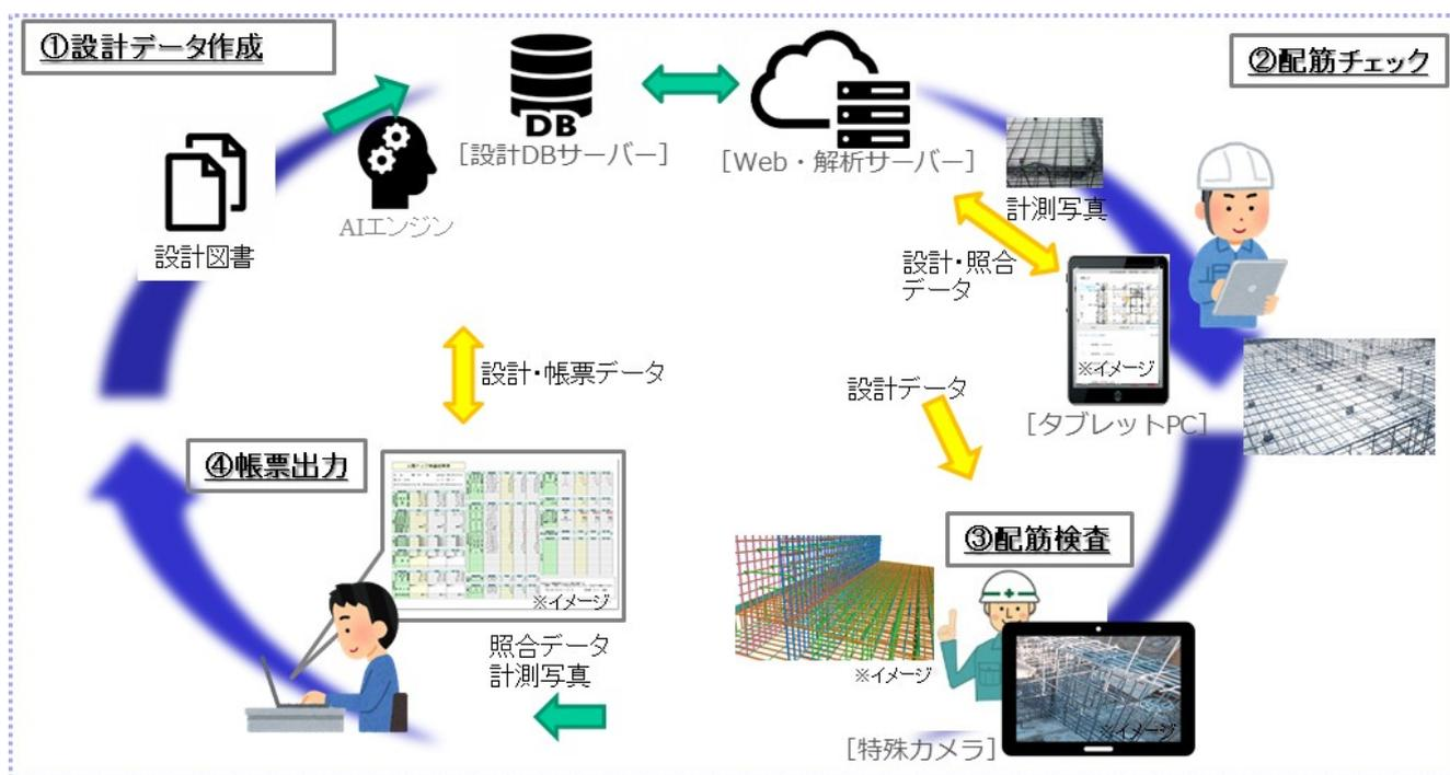
「配筋検査システム」の実装イメージ
