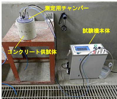
写真1 コンクリート供試体を用いての測定状況
