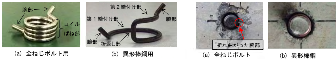
写真2 アンカー筋挿入後の状況
