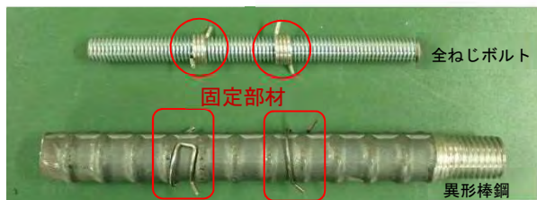
写真1 固定部材と固定部材を取付けたアンカー筋
