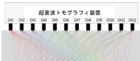
図1 超音波横波伝搬のイメージ
