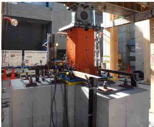
写真1 中低層建物を想定した複合型露出柱脚試験体
