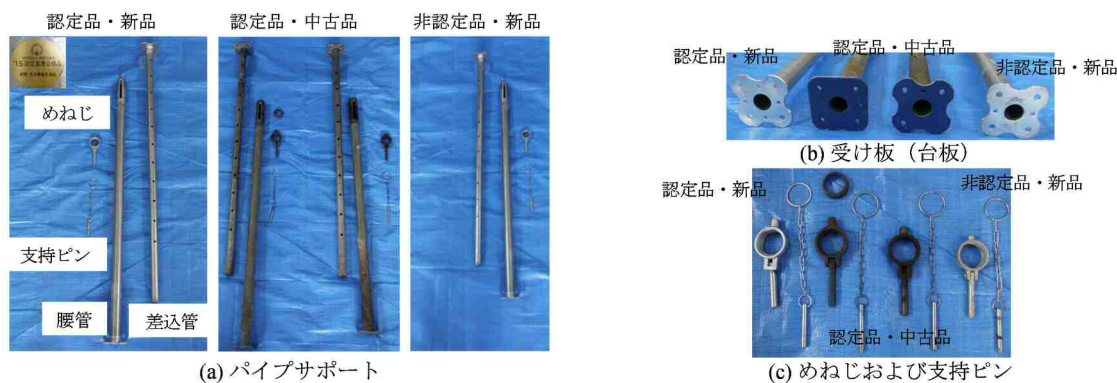
写真1 外ねじ式構造パイプサポート（試験体）
