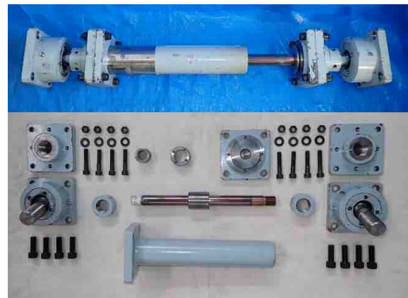
写真1 摩擦ダンパーの構成部品
