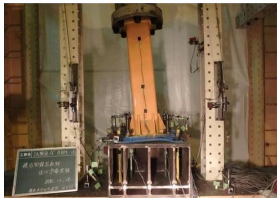
図4 基本性能確認実験加力状況
