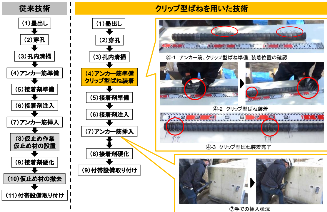
写真3 従来の施工手順とクリップ型ばねを用いた施工手順の比較
