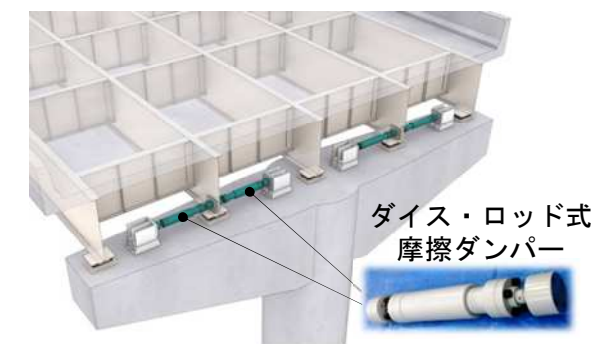
DRFダンパー設置状況
