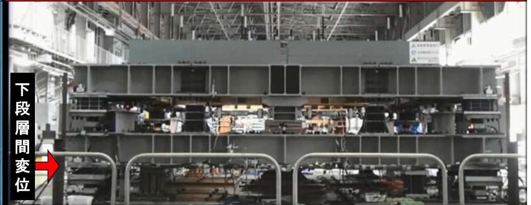
Case3(ゴム支承+100kN摩擦ダンパー):[補強後]
