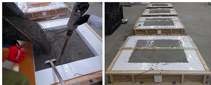
写真 1 床模擬試験体の打設や養生状況
