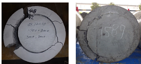
(a) 上面 (b) 底面 写真3 試験体の破壊状況 (A3-1)
