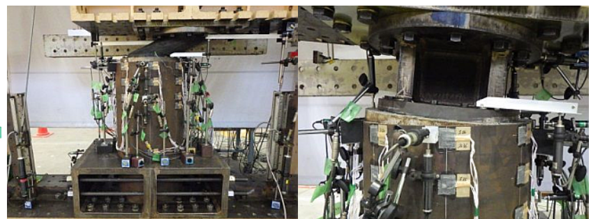
a) 積層ゴムを用いた加力 ( \gamma = +400\% ) b) 载荷治具を用いた加力(最大耐力) 写真1 実験状況 (B-1)
