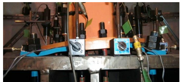
写真2 C-543 試験体加力状況 (柱部材角 1/17rad)
