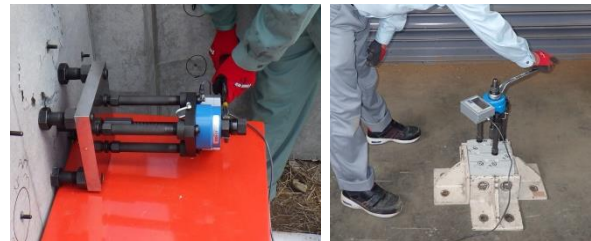
(a) 横向き引張試験状況 (b) 下向き引張試験状況
