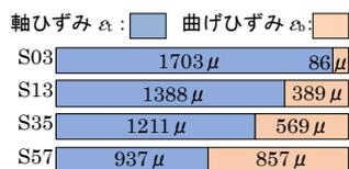
図 10 軸ひずみと曲げひずみの割合 (弾性限界時)
