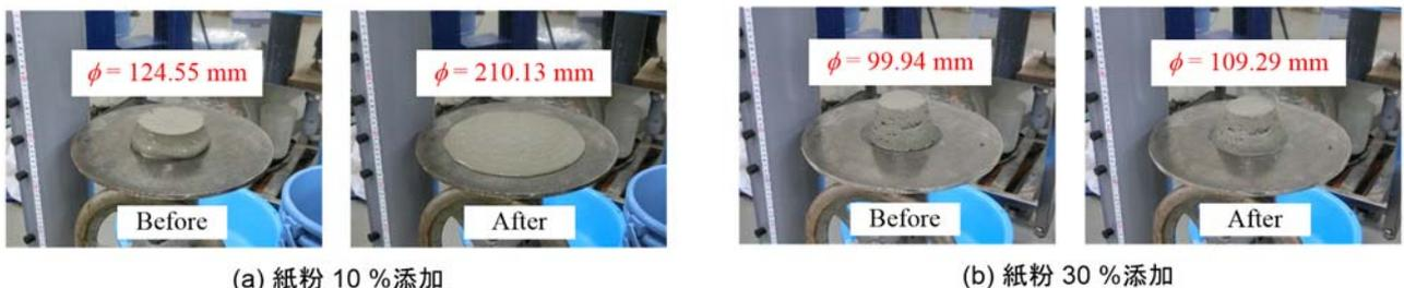
図-13 フロー試験前後における供試体の様子
