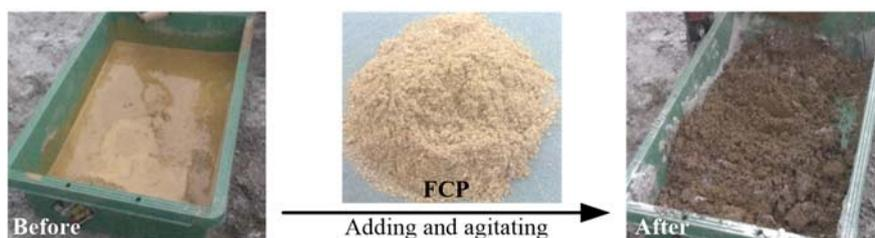
図-1 古紙を原料とする微細粉体を用いた高含水泥土処理<sup>6)</sup>
