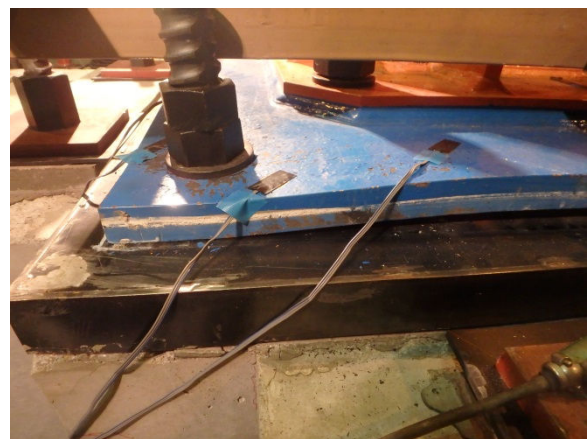
写真3 ベースプレート変形状況②
