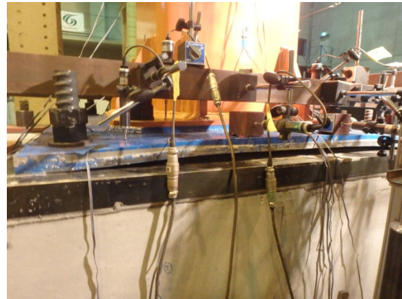
写真2 ベースプレート変形状況①
