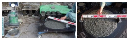
b) 高流動コンクリート
