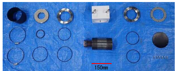
写真1 摩擦サイドブロックの構成部品
