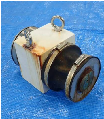
(b) 複合サイクル試験 800 サイクル後 写真 2 試験体の外観変化 (No. 9)
