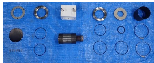
写真1 摩擦サイドブロックの構成部品
