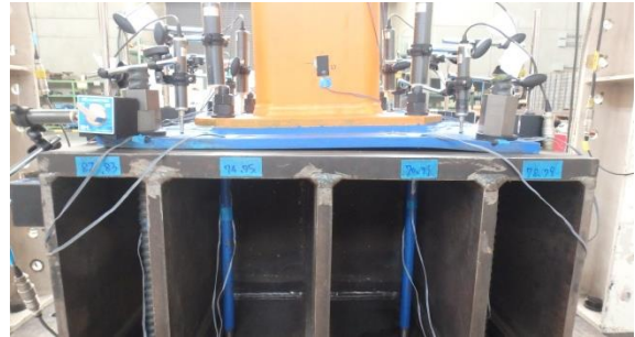
写真 1 複合型 PL40 柱部材角 R=1/33\text{rad} 加力状況
