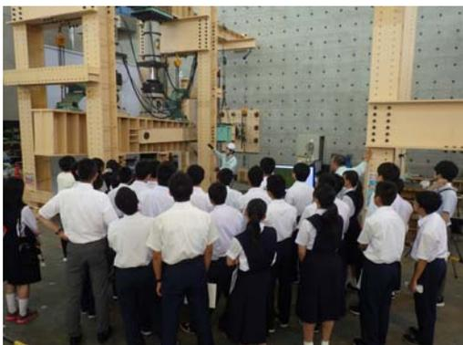
（橋梁用摩擦ダンパー加力試験）
