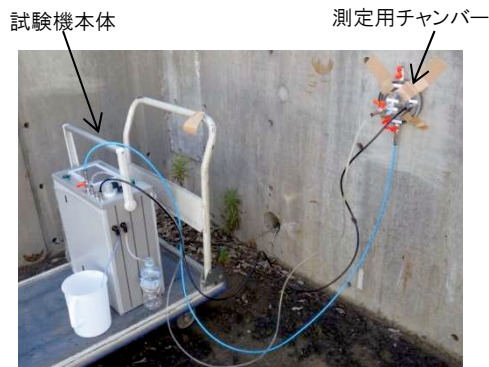
写真 1 WAPP を用いた透水試験実施状況
