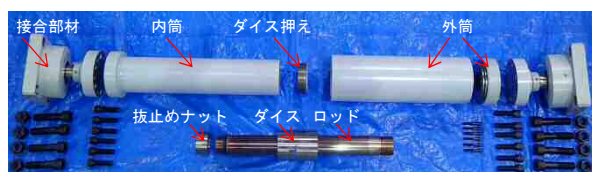
写真1 摩擦ダンパーの構成部品
