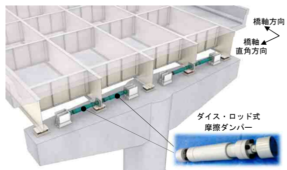
図1 摩擦ダンパーを用いた橋梁耐震補強工法
