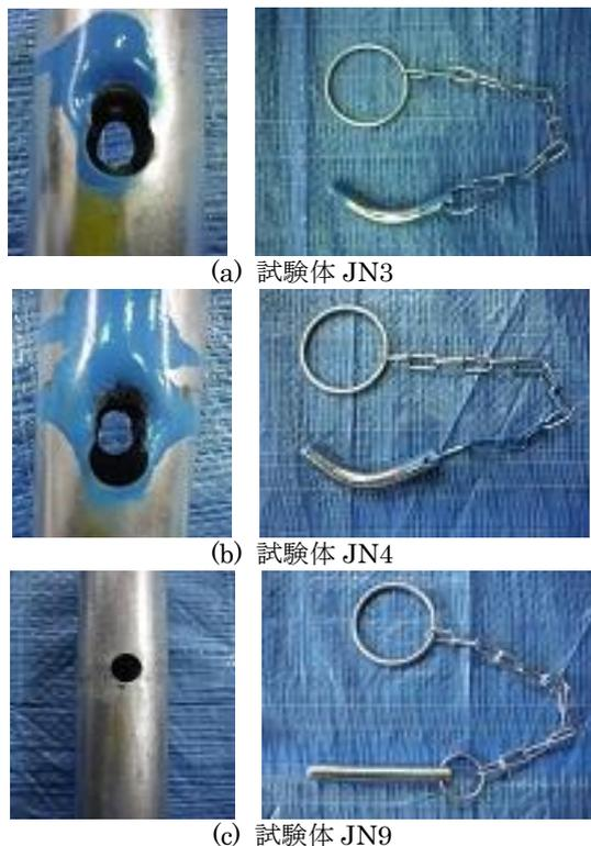
写真 3 実験後の残留変形
