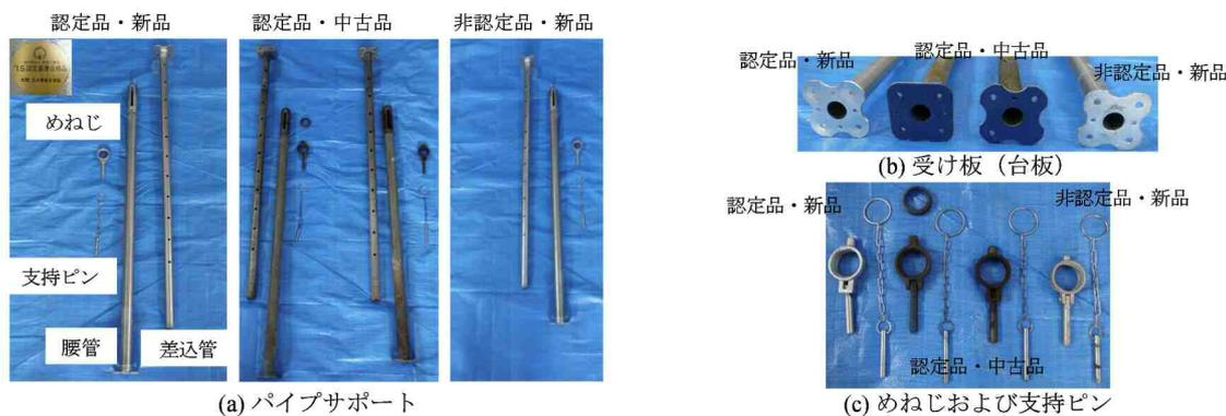
写真1 外ねじ式構造パイプサポート（試験体）
