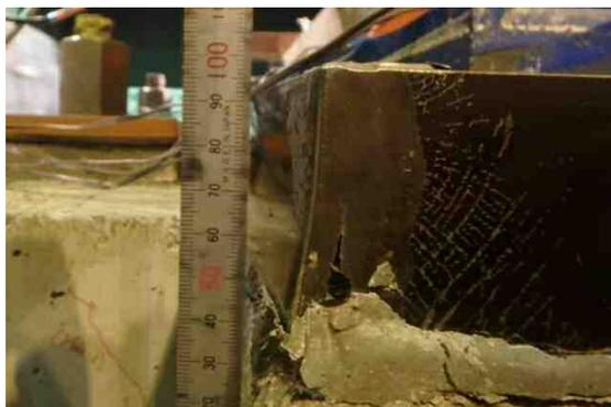
写真2 鋼製型枠に生じた亀裂
