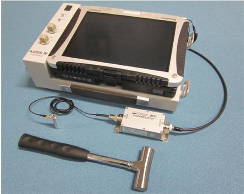
A photograph of the AURIS M non-destructive testing system. It consists of a white rectangular control unit with a black screen and several buttons. A black cable connects it to a smaller, silver-colored rectangular probe unit. A black handle with a silver metal tip is also visible, connected to the probe unit. | <p>構造物の形状寸法や内部に生じた亀裂を簡便に検知できる非破壊調査システムです。</p> <p>可搬性に優れた調査機器を用いて、コンクリート構造物や基礎杭などに発生したひび割れの有無、岩盤や転石の亀裂や根入れの調査が行えます。構造物の維持管理のための点検・診断技術として調査実績が増えています。</p> |
