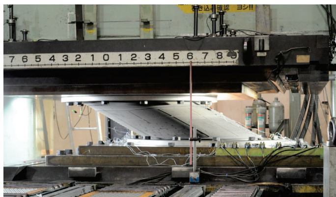
写真-1 免震部材（鉛プラグ挿入型積層ゴム）の傾斜実験状況写真例
